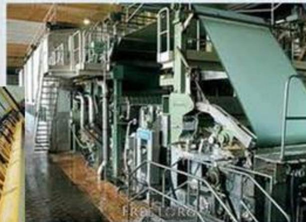
В настоящее время почти вся бумага производится мощными машинами на крупных фабриках. Машины распиливают бревна на чурбаки, снимают с них кору, разбивают чурбаки на щепки, которые направляются к котлу, где из них варится жидкая масса. А в другом котле из тех же щепок варят клейкую целлюлозу. Затем оба вещества перемешивают. Эта смесь проходит через бумагоделательную машину, и после отжимки и отутюживания, отглаженная бумага отправляется в типографии – для печатания книг, газет и журналов.
